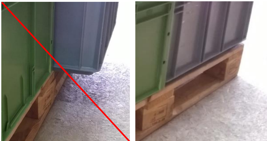
15) Ein Überstehen der Ware ist unzulässig.
