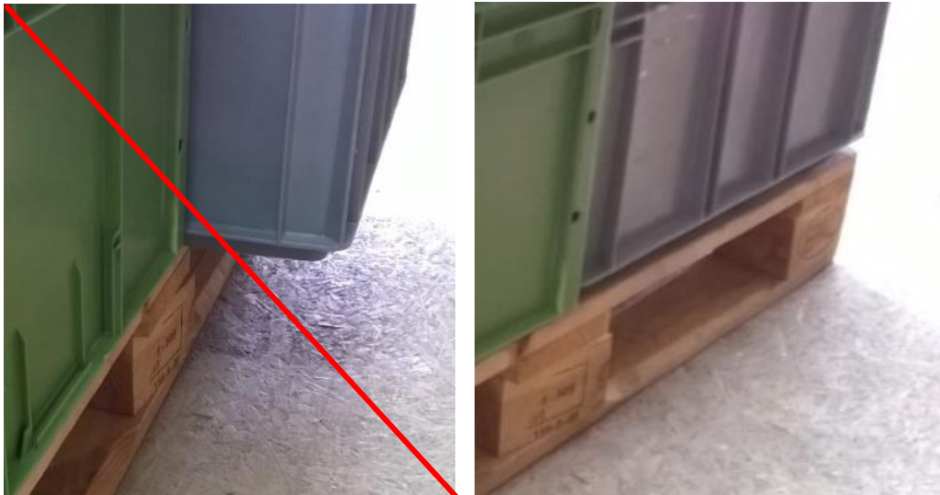
15) Ein Überstehen der Ware ist unzulässig.
