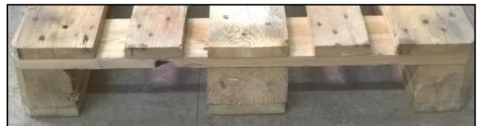
4) unterfahrbare Palette (min. 10 cm Unterfahrhöhe)
