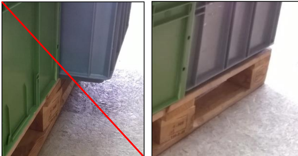
15) Ein Überstehen der Ware ist unzulässig.
